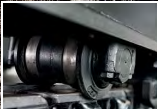
Entièrement repensé, le galet inférieur empêche la boue de pénétrer dans la machine et de l'endommager.
