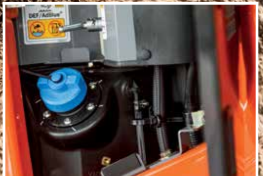
L'urée est injectée dans les gaz d'échappement pour réduire les émissions.
