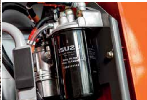
Le filtre à carburant principal est plus facile à remplacer.
